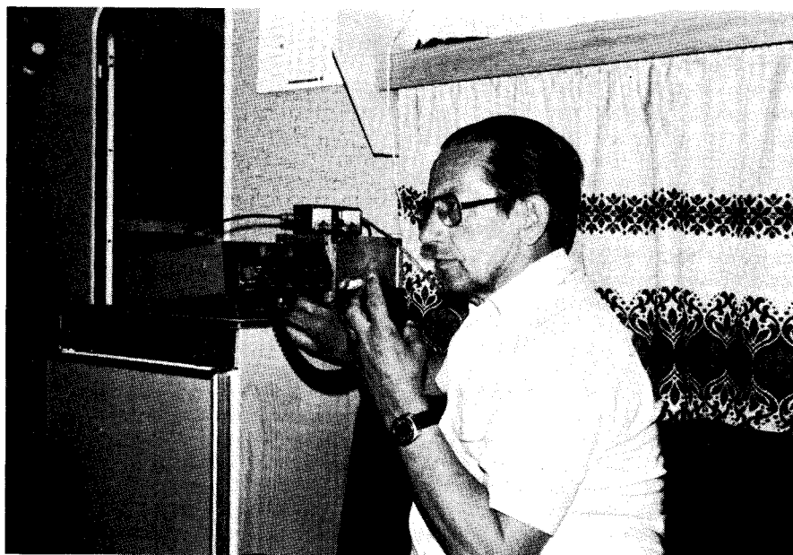
Het station PAoTV/IN3. De apparatuur, een FT7, een FP-4, antennetuner en SWR-meter, vond een plaatsje op de koelkast in de caravan. De operator was er bijna niet van weg te branden...
